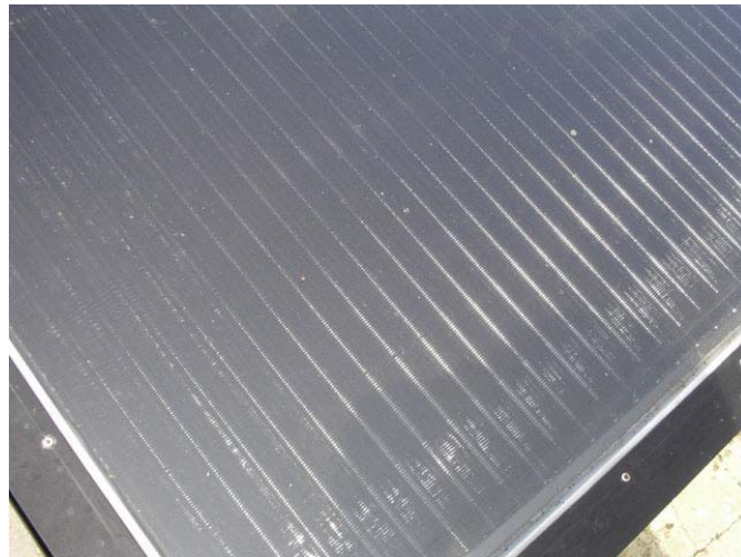
รูปที่ 4.1 ลักษณะของตัวเก็บรังสีอาทิตย์ที่นำมาทดสอบ
