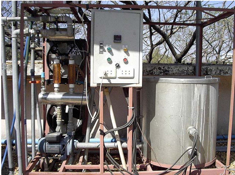
รูปที่ 4.4 ชุดอุปกรณ์ที่ใช้ทดสอบตัวเก็บรังสีอาทิตย์
