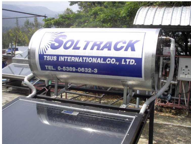
รูปที่ 4.3 ถังเก็บสะสมน้ำร้อนที่ใช้ในการทดสอบ
